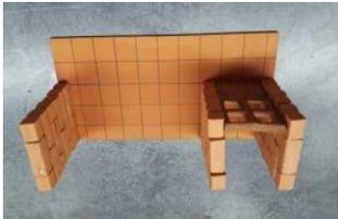
3. Montez les deuxièmes rangs en commençant par une demi brique de façon à monter les briques en décalé. Continuez ainsi jusqu'au 6<sup>ème</sup> rang.
